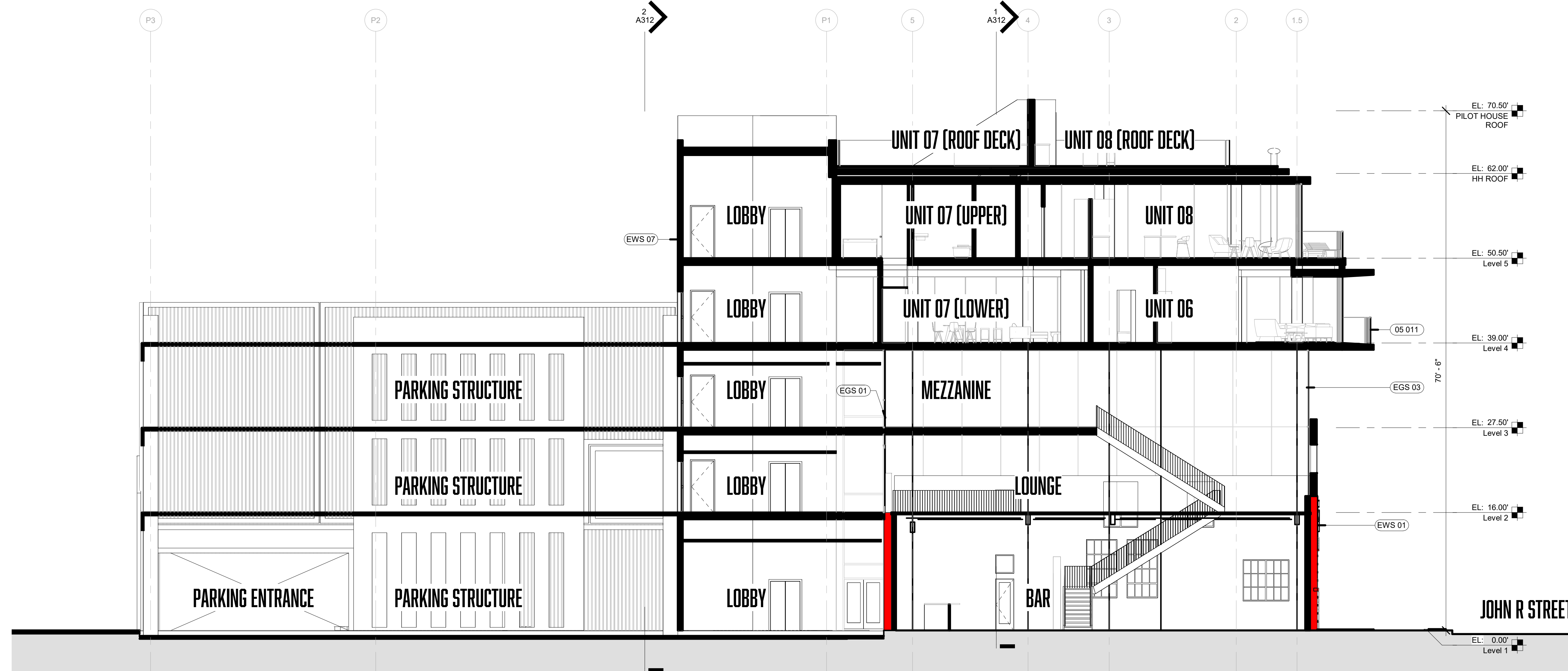
1 Longitudinal Building Section 1 Scale: 1/8" = 1'-0"
