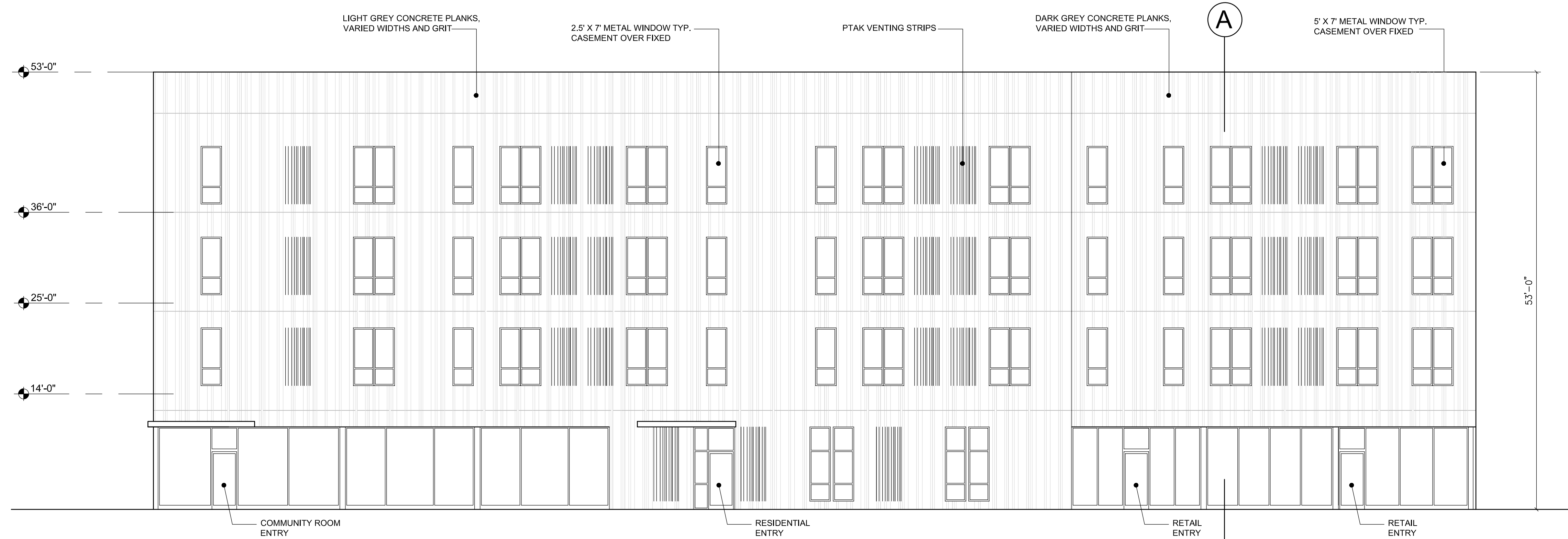
EAST ELEVATION SCALE: 1/8" = 1'-0"
