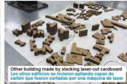
Other building made by stacking laser-cut cardboard Los otros edificios se hicieron apilando capas de cartón que fueron cortadas por una máquina de laser
